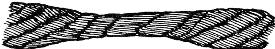
Рисунок 7. Перекручивание каната
