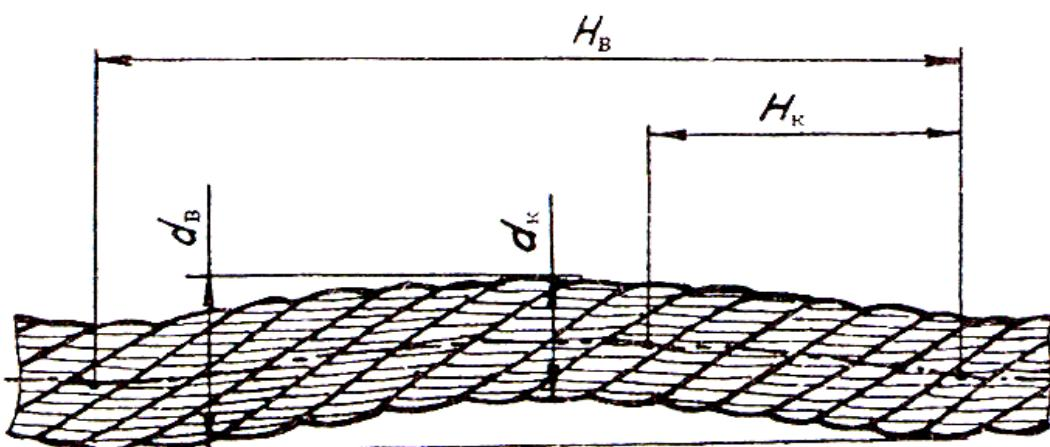
Рисунок 2. Волнистость каната
